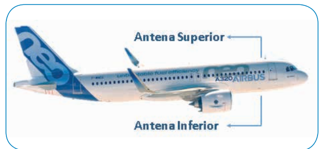
Figura No. 4. Localización de antenas de la aeronave. (Airbus, 2016)
