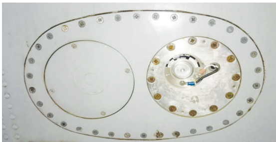
Figura 8. Tapa de inspección-bomba de combustible N/P 2C37-2 Flota C-212 FAC1258
