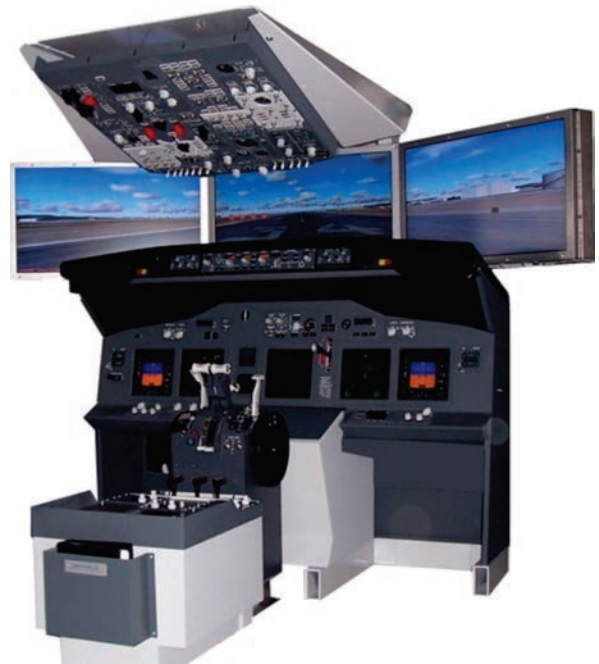
Figura 14. Sistema de visualización con 3 monitores NO da una completa sensación de inmersión visual en el simulador [13].
