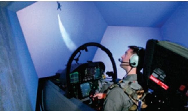
Figura 15. Sistemas de visualización tipo CAVE para simuladores de vuelo. [14]
