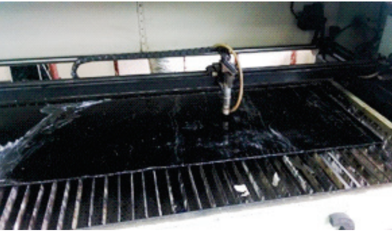
Figura 10. Fabricación de los paneles en cortadora láser
