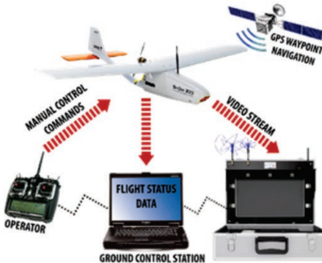
Figura 2. Arquitectura del Sistema GCS
