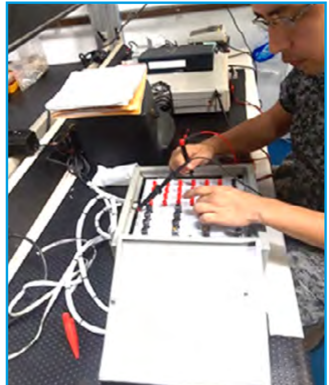
Figura 11. Pruebas iniciales a las conexiones. Fuente: Losada (2018).
