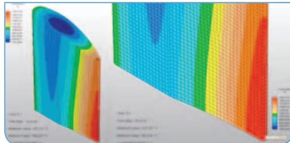
Durante todo el proceso de calentamiento, el nodo 7862 del borde de salida es el que siempre tuvo la máxima temperatura, como lo muestra la figura 10. La gráfica de la evolución de su temperatura se muestra en la gráfica 1
