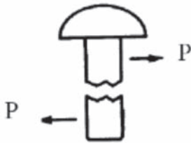
Figura 4. Corte del vástago por esfuerzo
