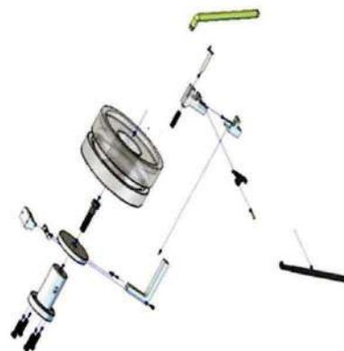
Foto 5. Vista explosionada de la herramienta. Sistema CAD.
