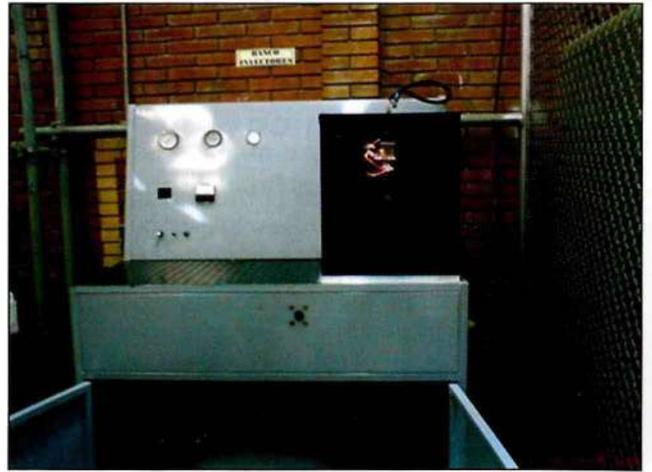
Foto 6. Banco de prueba de inyectores
