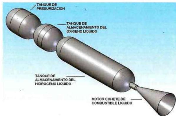
Fig. 5. Distribución sistema motor cohete de combustible líquido.
