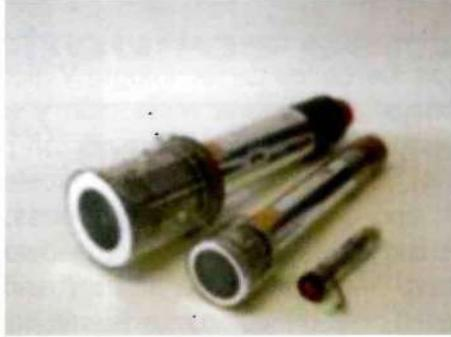
Figura 2: (Izquierda y centro: Tubo orticon de 4.5" y 3" usados en cámaras de televisión hasta los años 60. Derecha: Tubo vidicón de 1" usado tanto en la cámaras de televisión como en cámaras de seguridad)
