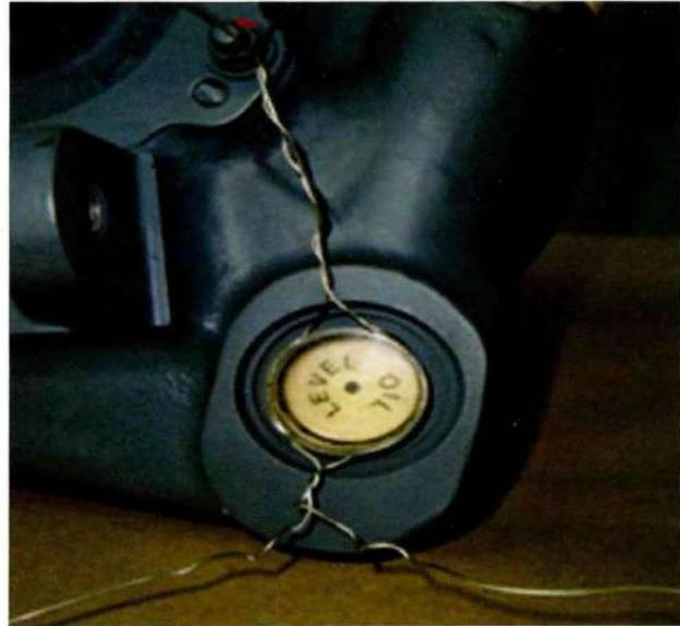
Foto 1. Visor de aceite de la caja de transmisión de un helicóptero
