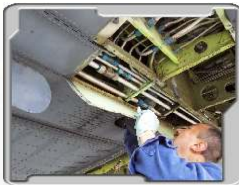
DESMONTE DE LA VALVULA DISTRIBUIDORA DEL AVION
