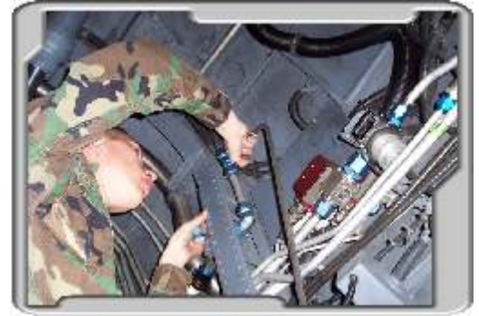
ACOPLE DEL PROBADOR EN EL AVION
