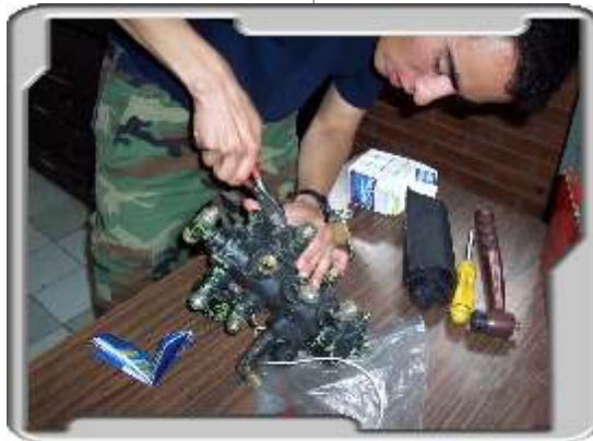
INSPECCION DE LA VALVULA DISTRIBUIDORA
