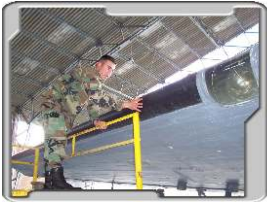
VERIFICACION DE FUGAS EN LAS BOTAS CON EL PROBADOR
