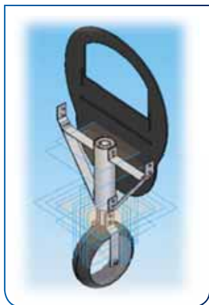
Figura 8. Configuración del tren de nariz
