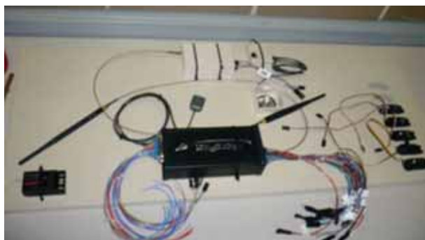
Figura 9. Banco de pruebas sistema de Autopilot MIRCROPILOT
