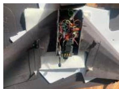
Figura 19. Ensamble final del ala zagi
