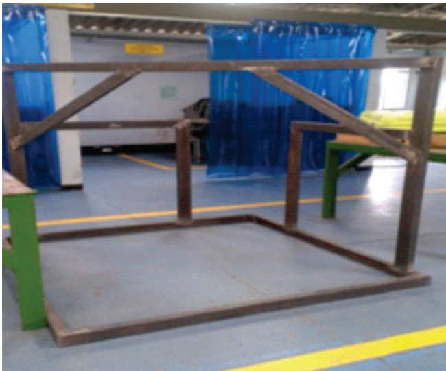
Figura 5. Estructura banco. Fuente construcción del prototipo del banco de almacenamiento y transporte para las hélices del A29, T27 y ARAVA.
