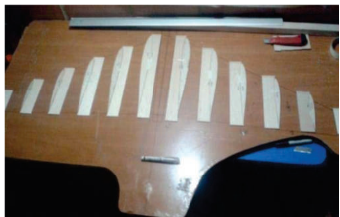
Figura 19. Alineación de Jigs Fuente: Bogotá, Colombia; Autores
