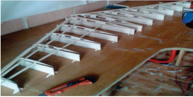
Figura 20. Pegado de largueros a las costillas Fuente: Bogotá, Colombia; Autores
