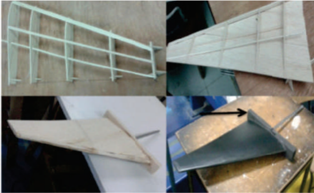
Figura 9. Construcción del modelo del perfil a escala [1:1.4] Fuente: Autores 2014
