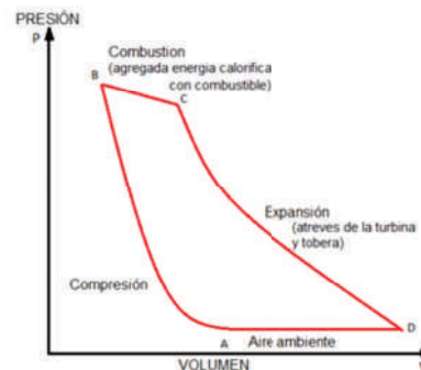
Figura 3. Diagrama del ciclo Brayton
