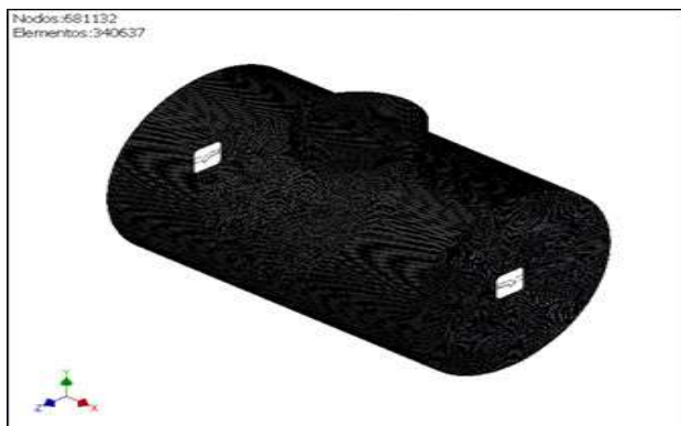
Figura 6. Prueba Mallado Tanque.
