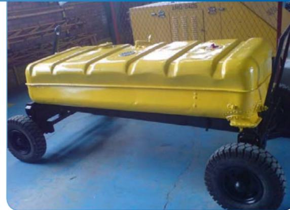
*Banco de Drenado de las Celdas de Combustible de los Helicópteros UH-1H*
