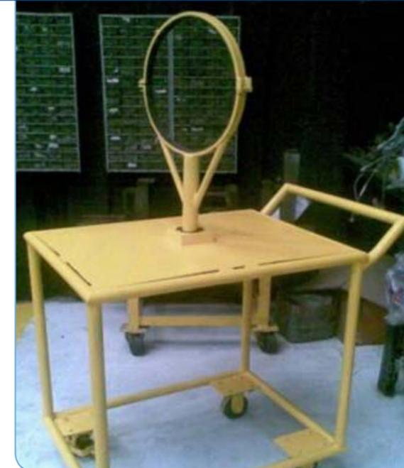
*Banco de Ensamble de la Sección Caliente del Motor J-69-T-25A de los Aviones T-37*
