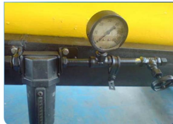
*Bomba Neumática y Medidor de Presión del Banco de Drenado*
