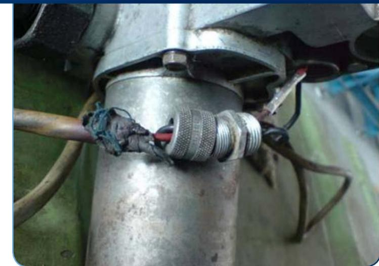
Tubo Empleado para el Drenado de las Celdas de Combustible
