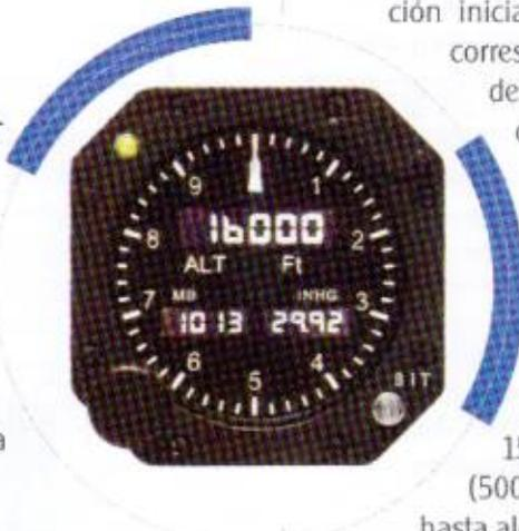
que la lectura sea tomada. Después que la lectura sea tomada, la presión debe continuar incrementándose en la misma forma anterior, hasta que se alcance la presión atmosférica. La lectura del altímetro en cualquiera de los dos puntos de prueba no debe diferir mucho más de la tolerancia especificada en la Tabla II de la lectura del altímetro para la correspondiente altitud registrada durante la prueba de error de escala descrita en el párrafo referente a la histéresis;
