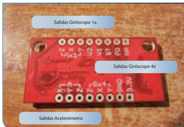
Figura 7. Patas de conexión de la unidad inercial.
