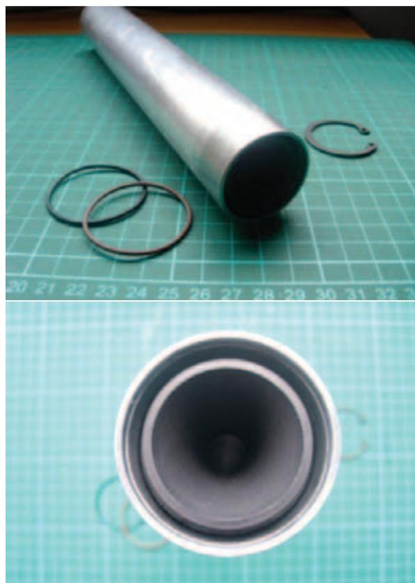
Figura 10. Motor cohete ensamblado y sus partes.
