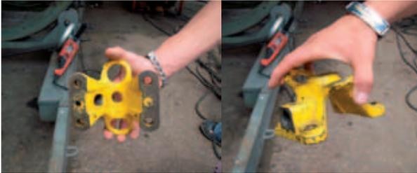
Vista inferior de la pieza que se soldara con soldadura west arco 7018 a los tensores que van desde el punto duro de la parte trasera del motor ubicado a las 12 hasta los aros para poder girar el motor en su eje longitudinal.
