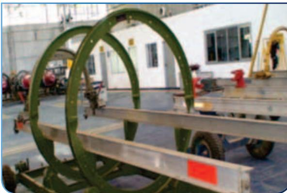
Fig. 2 Banco actual utilizado para motores ATAR 09C-5, el cual posee mecanismos para hacerlo rotar 360°
