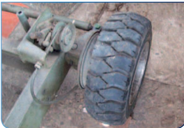
La balinera muestra la medida a la cual debe quedar el pasador el cual será soldado al tensor que sujeta el motor en su parte trasera a las 3 y a las 9 de los aros.
