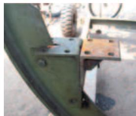
Vista superior de los soportes que van a unir mas los rieles que sostienen el motor J79-J1E ya que tiene menos diámetro que el motor ATAR 09C-5 el cual es el motor que tiene actualmente un banco de trabajo con la capacidad de girar 360 grados en su eje longitudinal.
