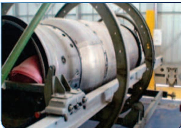
Fig. 3 Banco a modificar del motor ATAR 09C-5, el cual también posee mecanismos para hacerlo rotar, tiene que ser adaptado para el motor J-79JIE
