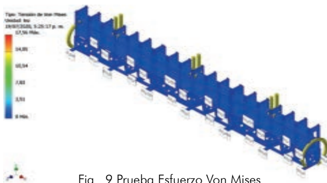
Fig. 9 Prueba Esfuerzo Von Mises
